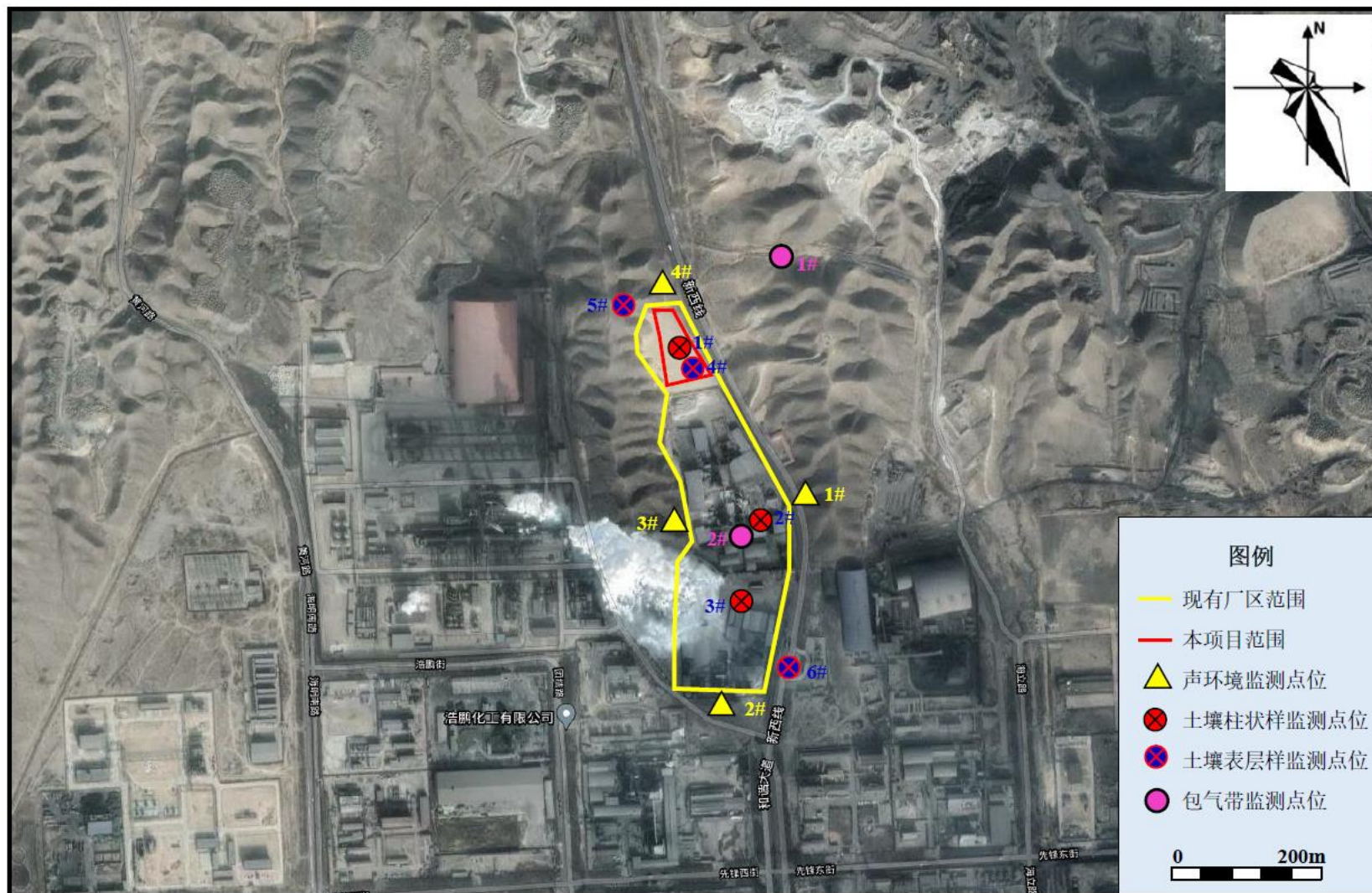
图 5.3-1 声环境、土壤环境、包气带环境监测点位布置示意图
